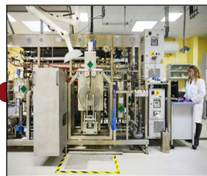
Plateforme d'essais en milieu CO 2 supercritique
