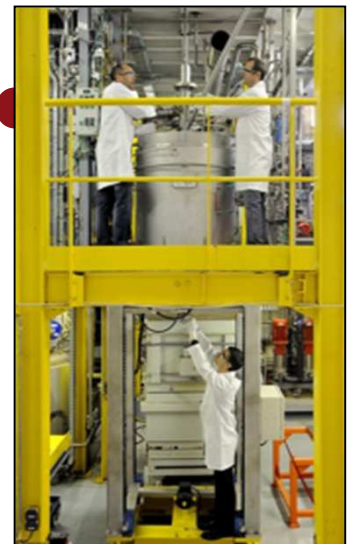
Vitrification « In Can-Melter »
