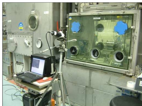
Mesure d'imagerie alpha en boîte à gants
