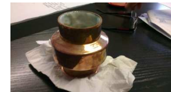
Noyau miscible réalisé par prototypage rapide
