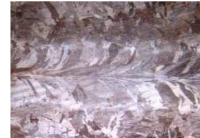
Soudure Fe sur CuCrZr
