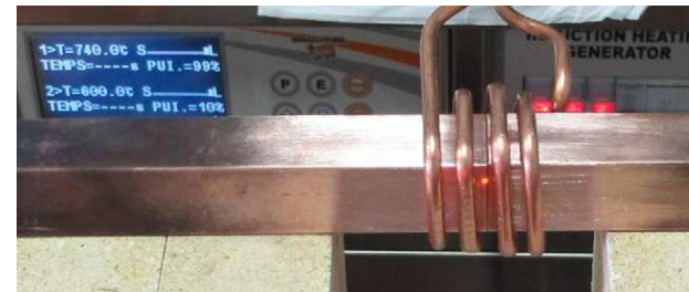
Assemblage des conducteurs des bobines divertor WEST
