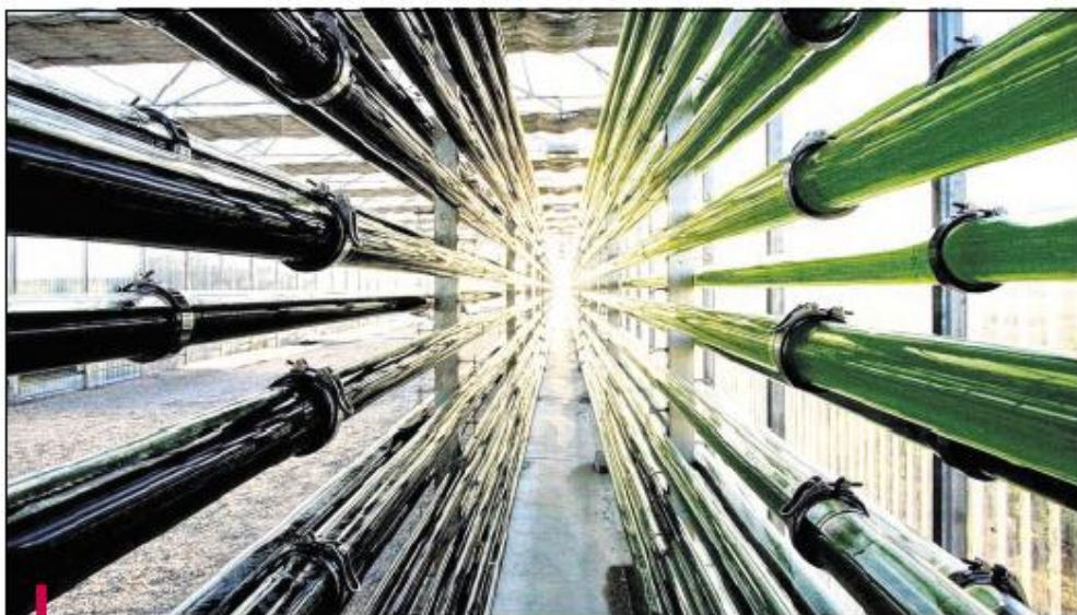
Voici un photobioréacteur destiné à produire de la biomasse. Les tubes sont transparents pour laisser passer la lumière. À l'intérieur, circule l'eau dans laquelle sont les microalgues qui se multiplient et donnent la couleur verte.
