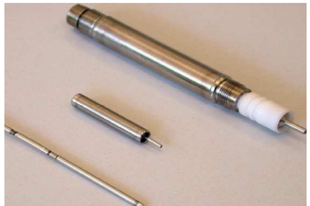
Chambres à fission (diamètre 1,5mm, 4mm, 8mm)
