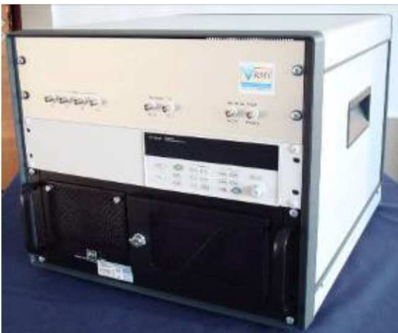
Chaîne de mesure brevetée pour la détection des neutrons de forte énergie
