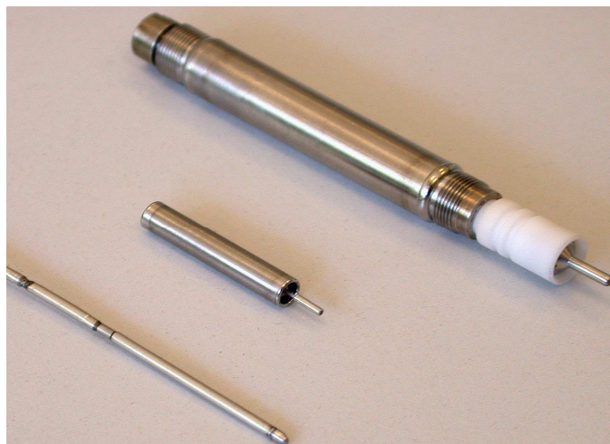
Chambres à fission ( \varnothing 1,5 mm, 4 mm, 8 mm)
