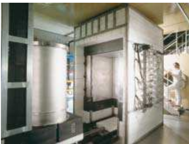
Cellule de mesure neutronique SYMETRIC destinée à la caractérisation de la matière fissile dans des colis irradiants
