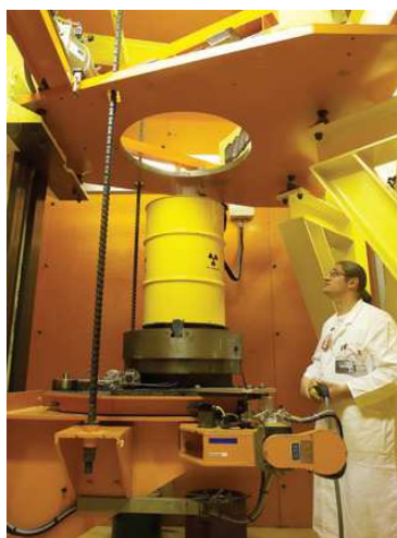
Cellule d'imagerie gamma TRANSEC pouvant accueillir des colis irradiants jusqu'à 200 litres / 500 kg
