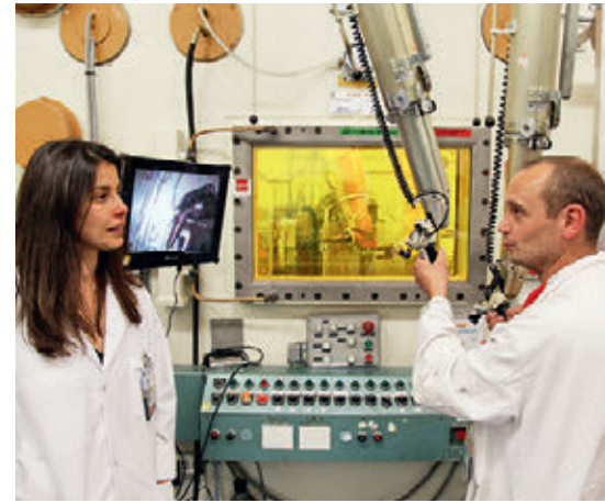
Dans les laboratoires chauds destinés à la manipulation de matériaux radioactifs, Amel Petitrenaud discute avec Damien Schildknecht, technicien. Grâce à des bras télémanipulateurs, il prépare des échantillons à partir d'un morceau de gaine de combustible d'une centrale nucléaire.
