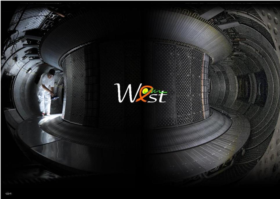
*Vue de l'enceinte à vide WEST avec sa nouvelle configuration et les prototypes ITER de composants face au plasma éclairés par le technicien. © CEA/C. Roux /CEA Cadarache, le 22 novembre 2016*
