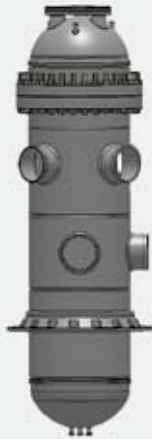
FIGURE 8 : VUE 3D DE LA CUVÉ REACTEUR ALLEGRO
