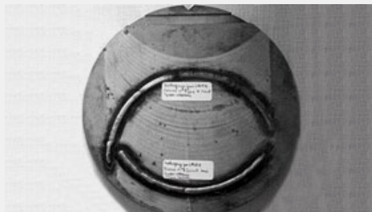
FIGURE 3.11 : NETTOYAGE LASER PUIS SOUDAGE SUR TÔLE MOUILLÉE EN SODIUM
