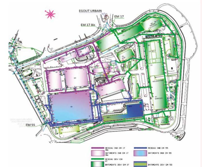
Figure 4: Implantation des émissaires et de l'égout urbain sur le site de Fontenay-aux-Roses.
