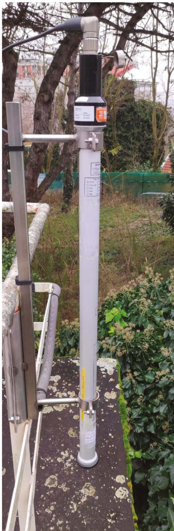
Dosimètre RPL et sonde gamma traceur.
