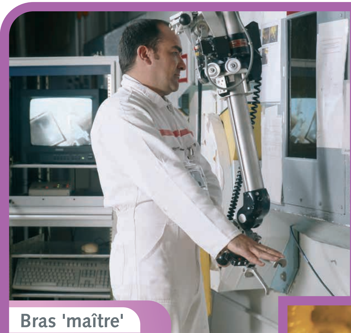
Télémanipulateur mécanique à retour d'effort.
