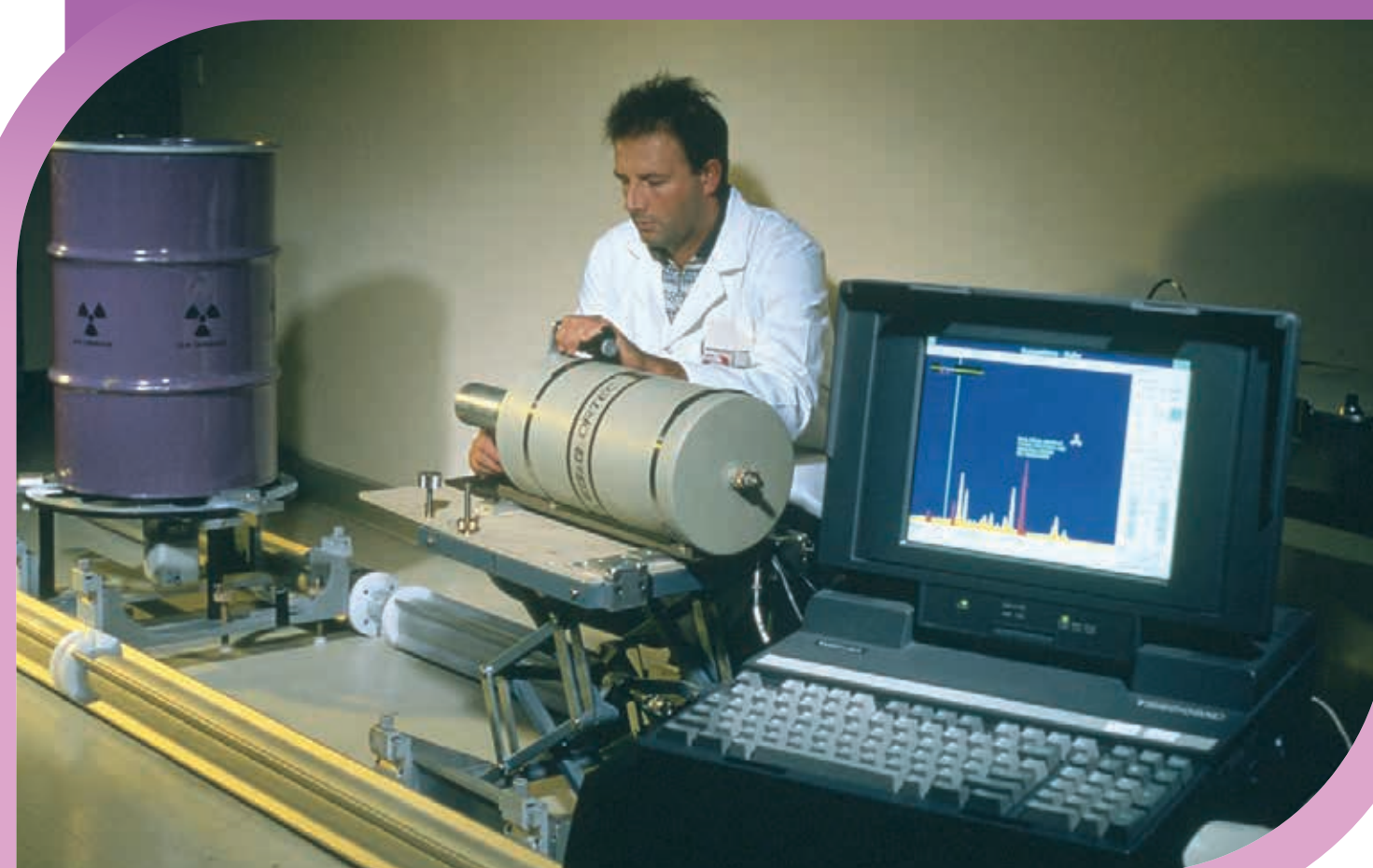
Spectrométrie alpha ( \alpha ) et gamma ( \gamma ) associée à un logiciel de modélisation
