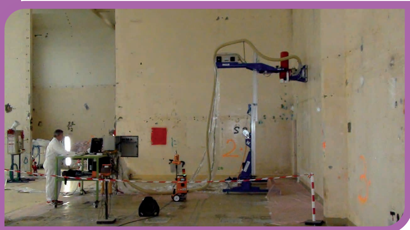
L'AspiLaser®, développé au CEA, pour le décapage par laser des surfaces contaminées.
