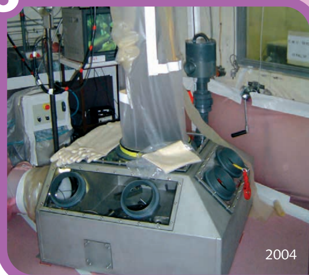
Mise en place d'une boîte à gants pour effectuer le prélèvement.
