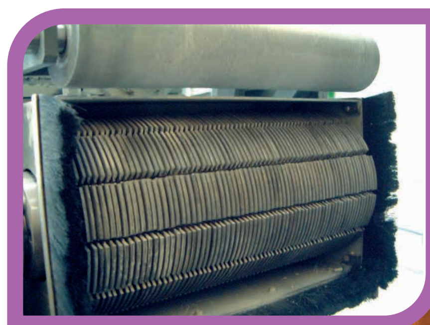
La raboteuse et la technique du sablage sont utilisées afin d'enlever de fines couches de béton ou de métal.
