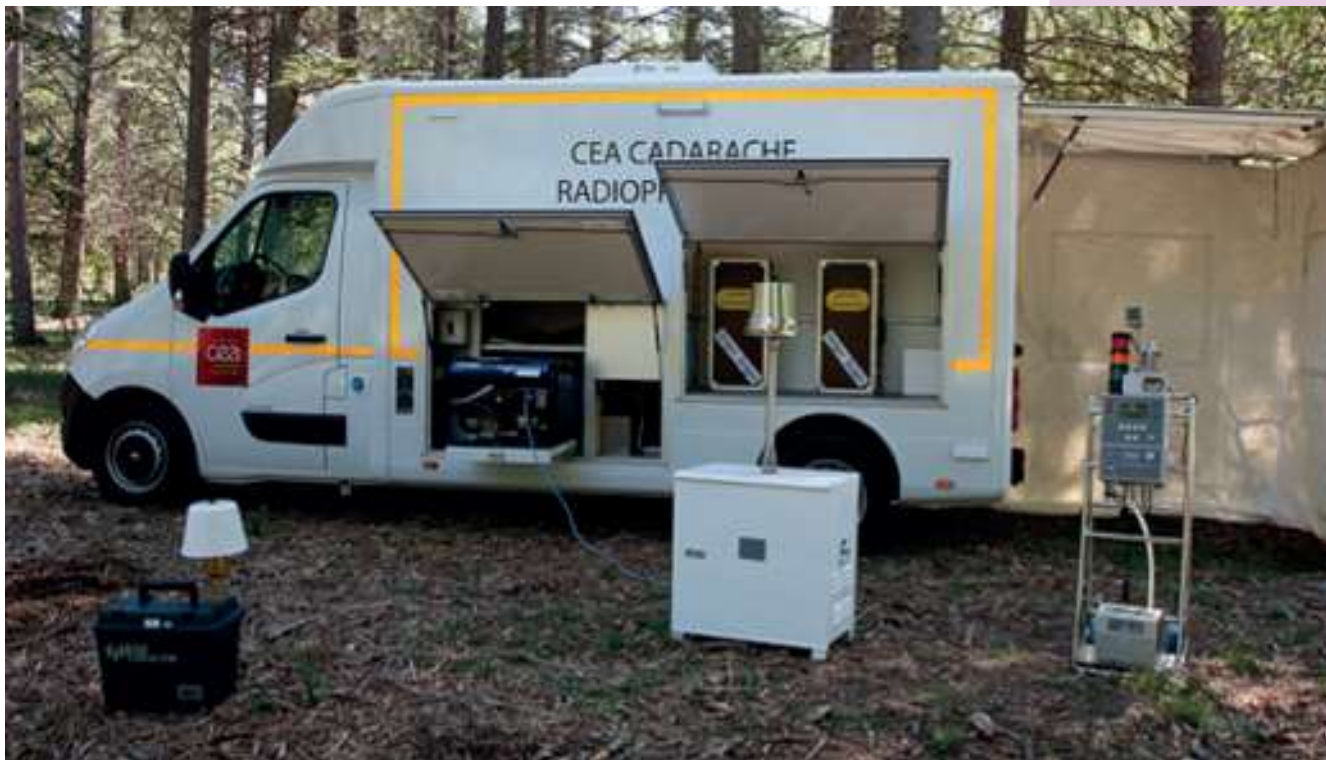
Véhicule d'Intervention et de Surveillance Atmosphérique
