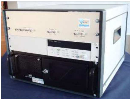
Chaîne de mesure brevetée pour la détection des neutrons de forte énergie
