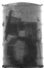
Imagerie haute énergie avec MINILINATRON : Expertise de colis de bitume sur le site de BELGOPROCESS
