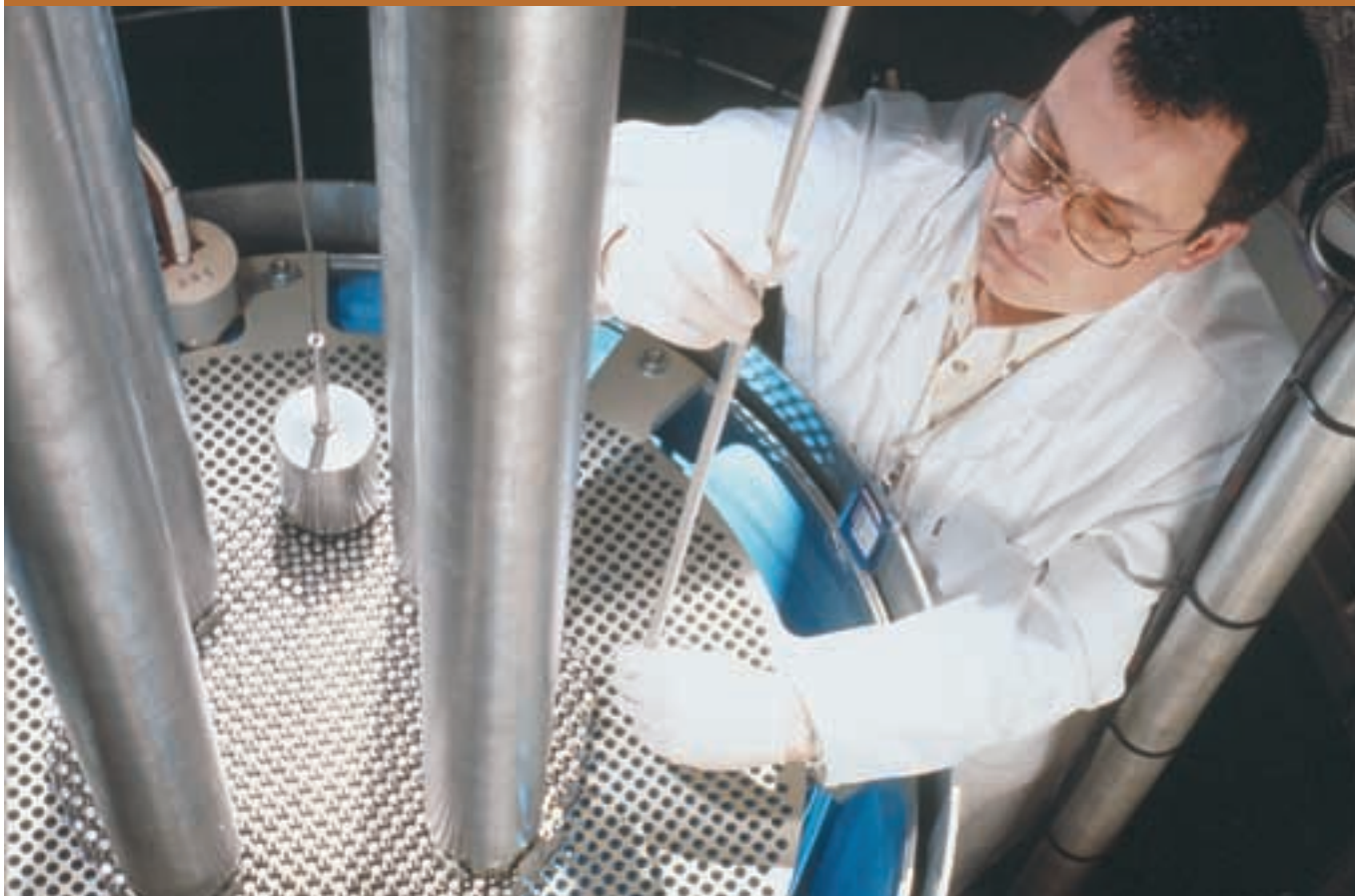
Crayons combustibles du réacteur expérimental Eole
