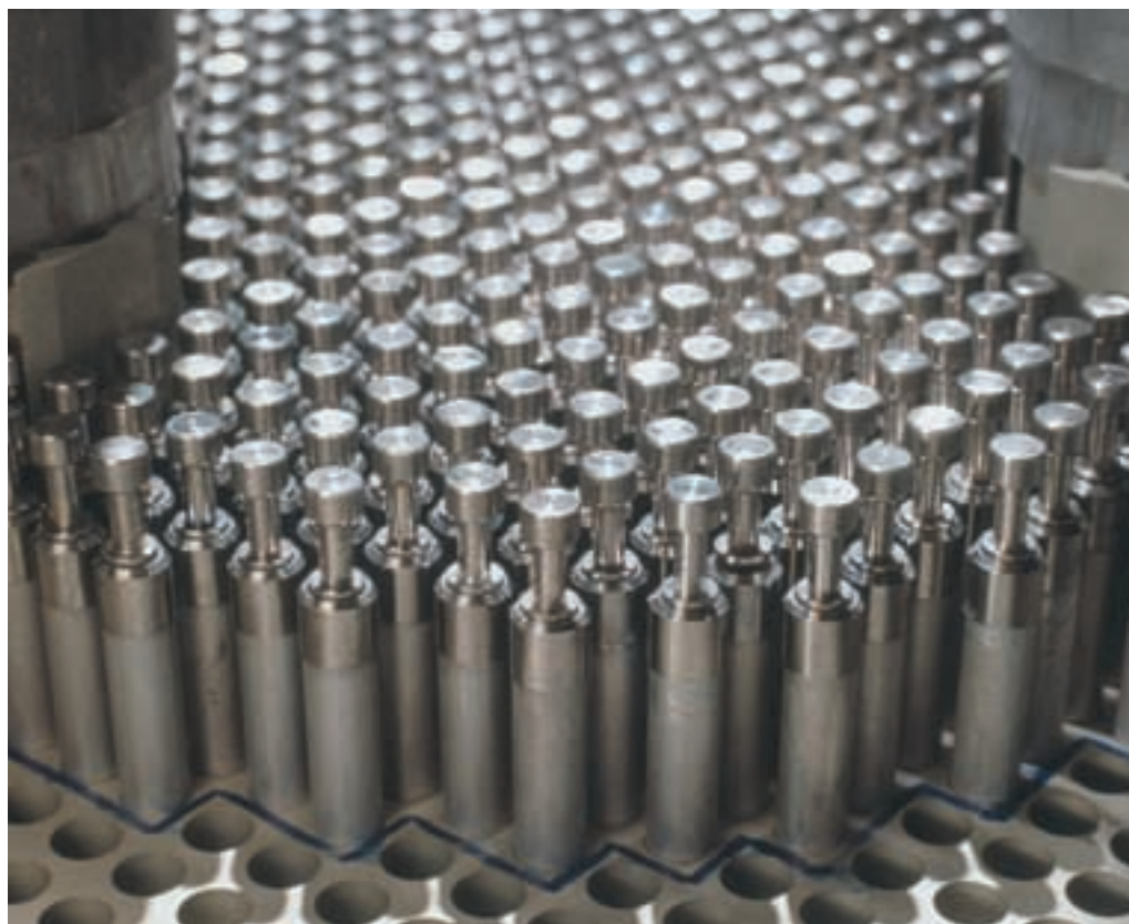
Gros plan du combustible du réacteur de recherche Eole
