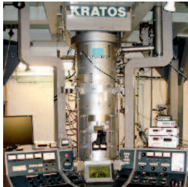
Fig. 104. Le microscope électronique à très haute tension (THT) du CEA Saclay. Cet appareil permet d'irradier des échantillons avec des électrons d'énergie maximale 1,2 MeV et un taux de création de défauts pouvant atteindre environ 5 10 -3 dpa/s.
