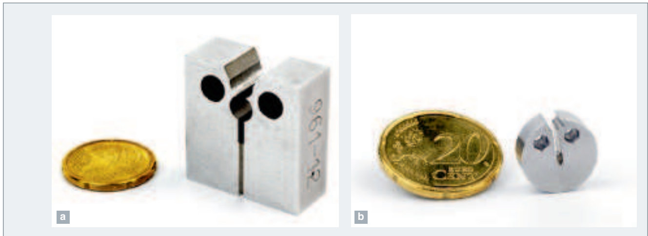
Fig. 79. Éprouvettes de ténacité de type (a) CT-10, (b) CTR-5.
